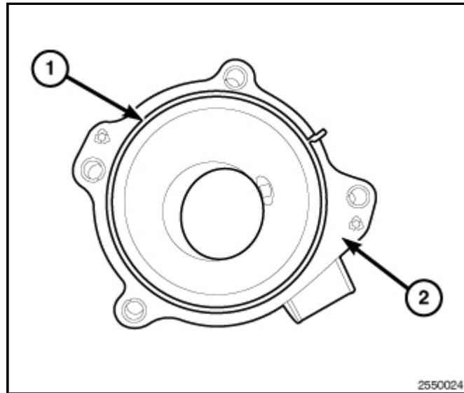
4. 安装EGR进气流量控制阀 (3) 到预燃烧室。 紧固螺栓(2)至 9 N·m(80 in. lbs.)。
