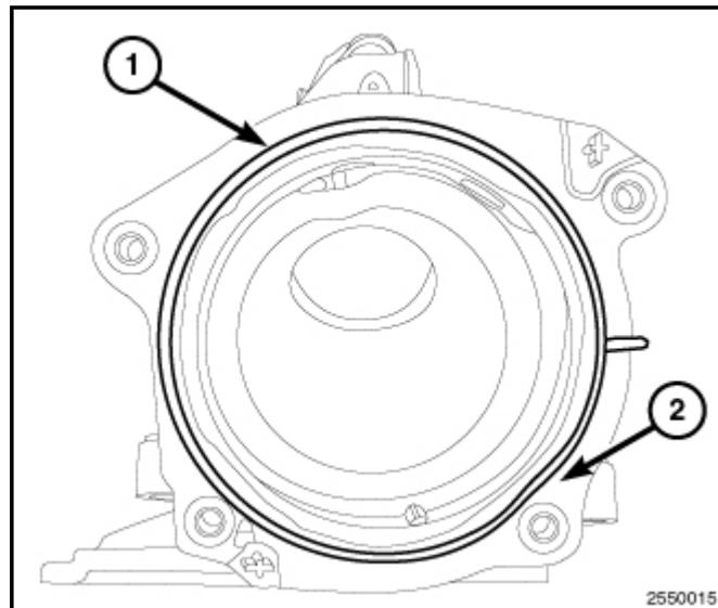
3. 安装新垫圈 (1) 到进气管路 (2).
